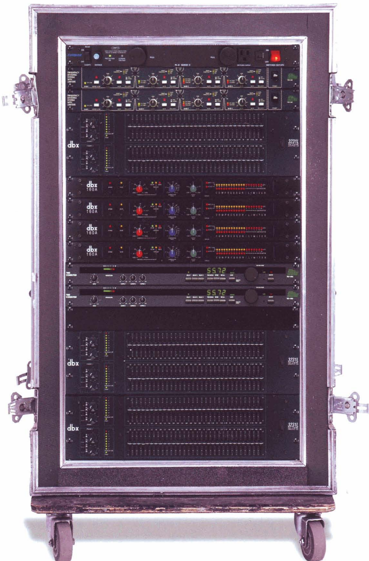
Konventionelles Drive-Rack mit diskreten 19“-Geräten
